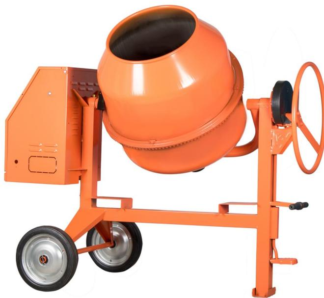
Durch das Handrad mit Untersetzung lässt sich die Trommel auch im gefüllten Zustand spielend leicht in jede gewünschte Position bringen, die stabile Feststellbremse mit Fußbedienung fixiert sie dort sicher. Das dreifache Rührwerk sorgt für beste Mischergebnisse in jeder Stellung.
