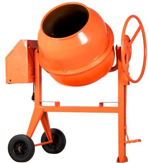
Gut 150 Liter Mischgut kann auf Grund der großvolumigen 180L - Trommel in einem Arbeitsvorgang gemischt werden. Ausgestattet mit einem Gussritzel, einem Gusszahnkranz sowie einer großzügig dimensionierten Trommellagerung ist dieser Profimischer ausgelegt für einen langen, reibungslosen Betrieb auf der Baustelle. Eine regelmäßige Wartung wird durch spezielle Schmiernippel möglich und erhöht die Lebensdauer zusätzlich.
